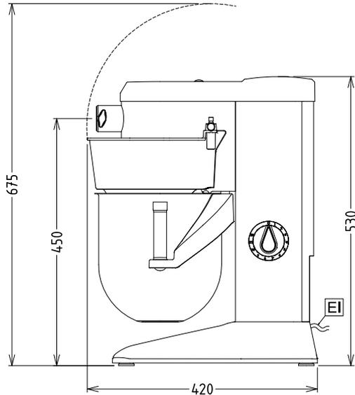
EI = Conexión eléctrica (energía)
